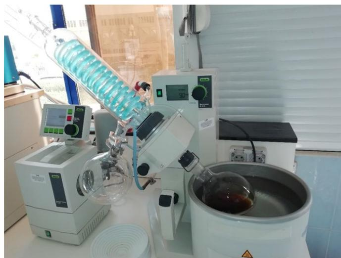
**Figure IV.5 :** Evaporation de l'extrait hydrométhanolique.
