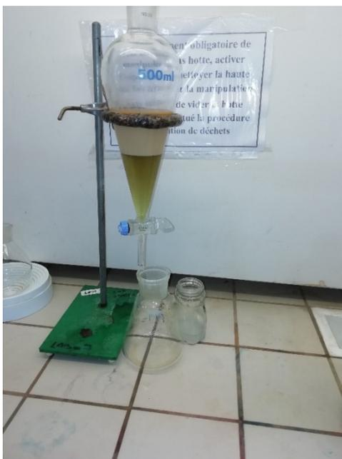
**Figure IV.8 :** Extraction liquide-liquide par le Chloroforme.
