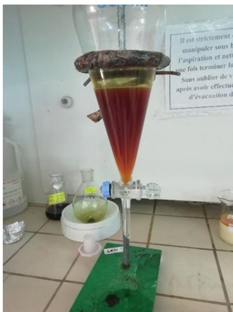
**Figure IV.9 :** Extraction liquide-liquide par l'acétate d'éthyle.
